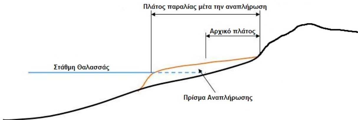
Σχήμα 2.1: Τεχνητή αναπλήρωση ακτής.
